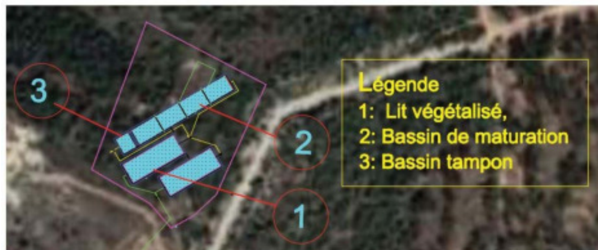
FIGURE 8. VUE D'ENSEMBLE DES OUVRAGES DE POST-TRAITEMENT
